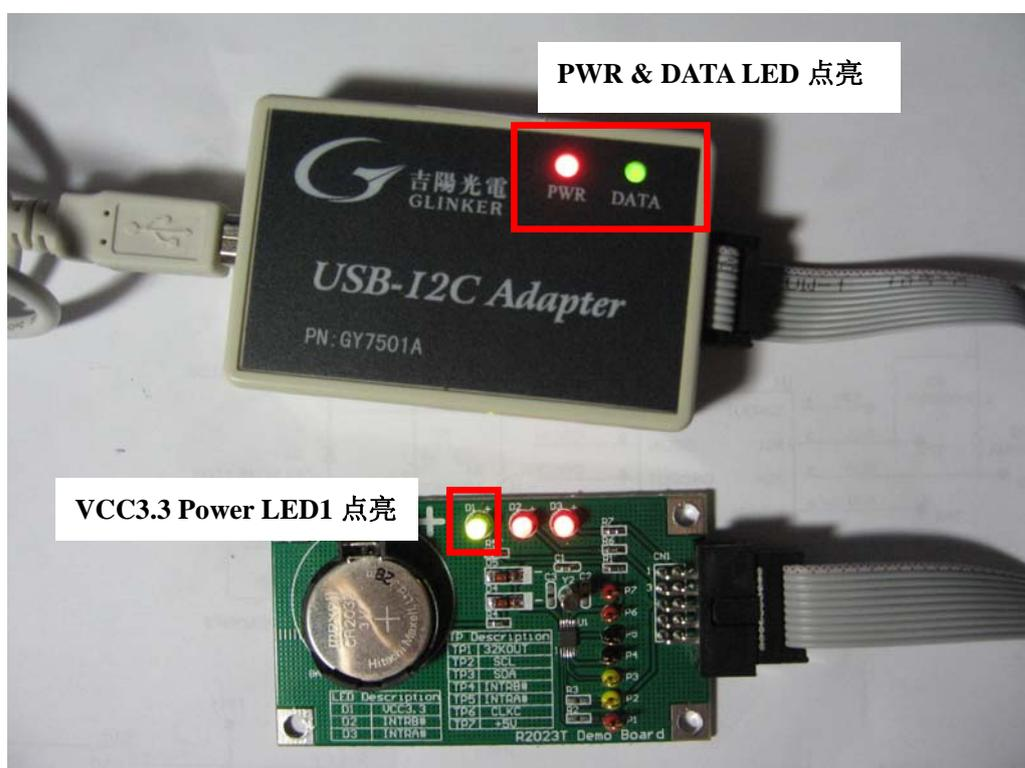
3、使用时注意开启及关闭顺序，开始使用时，先将连接 OK 的测试平台通过插入 USB 接口，然后在运行 I2C Tool 软件，退出使用时，先关闭 I2C Tool 软件，然后载移除测试平台。如果不按此操作，将会在使用时弹出错误对话框并导致 device 打开失败。
